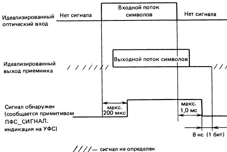
Рис. 8.9. Временные характеристики оптического приемника
